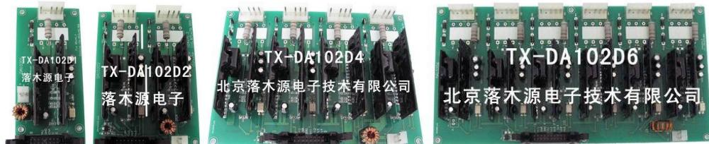
采用 TX-KA102 驱动芯片、TX-PD203 驱动电源，配合外围元器件组成的 IGBT 驱动板，具有 1、2、4、6、7 单元产品可选，即插即用，大大加快调试进度。
