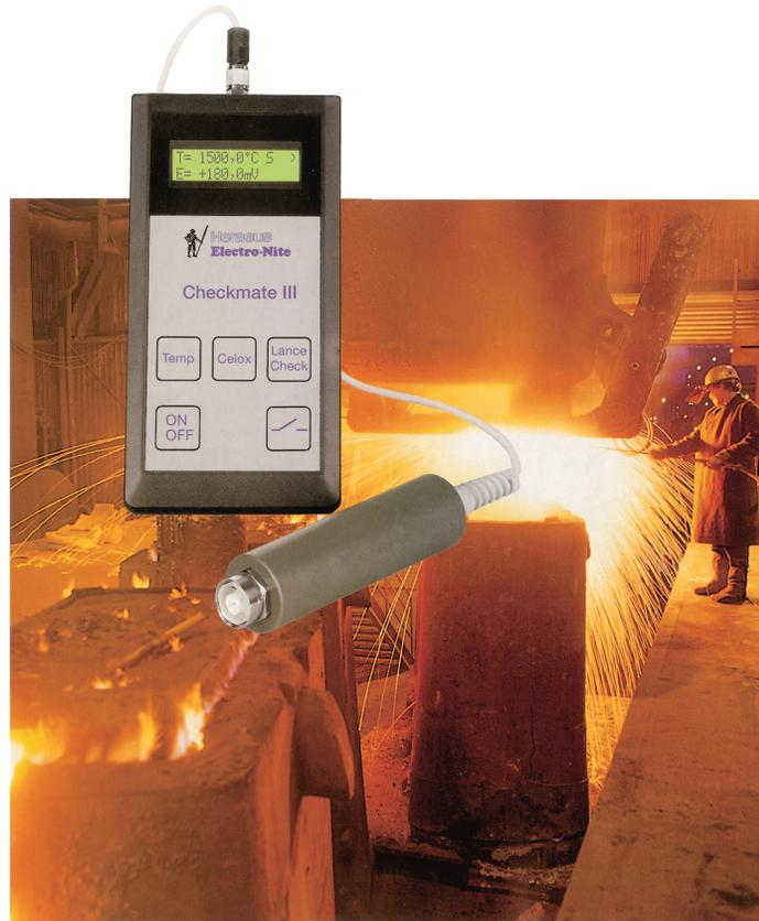
如果您在炼钢过程使用贺利氏电测骑士公司的测温定氧系统时，或是在铸造中采用我们的热分析系统进行热分析测量时，都需要对测量系统进行常规校验使之保持高温精度。
