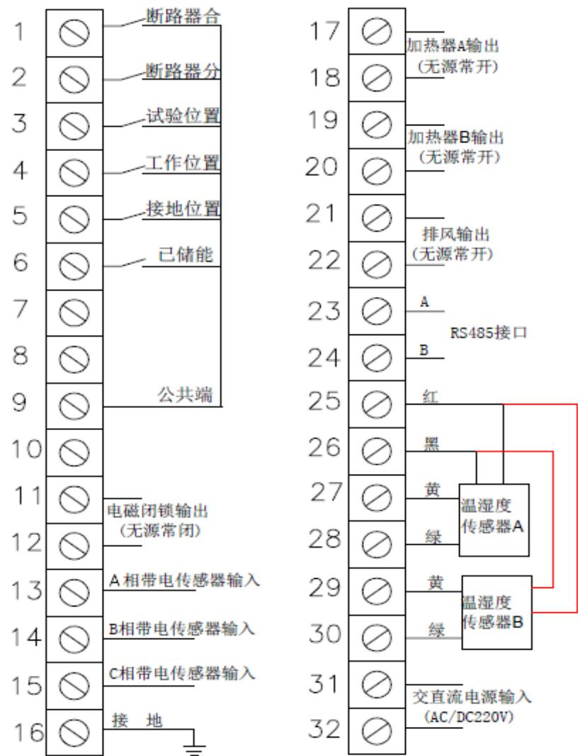
注意：在对开关柜一次系统做耐压试验时，如试验电压超过额定电压，请将本装置 13、14、15、16 号端子拔出并短接。
