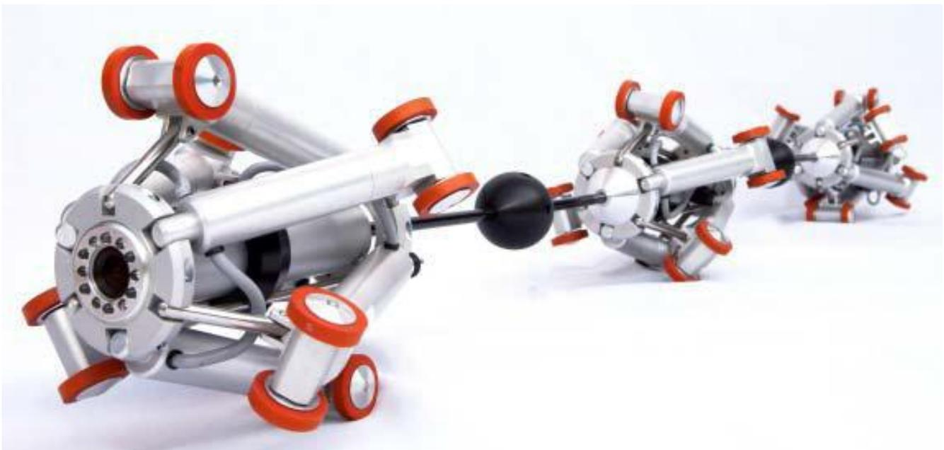
新模块化设计的管道内检机器人系统为视觉检测开辟新途径，检测管径范围从 48mm 到 1000mm
