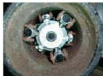
对于检测腐蚀或污染区域及材料内部缺陷, 推荐使用带广角镜头及遥控调焦的直视视频镜头。依据管道内检系统的类型及尺寸, 采用不同视频头为客户定制应用提供特别具有性价比的决绝方式。
