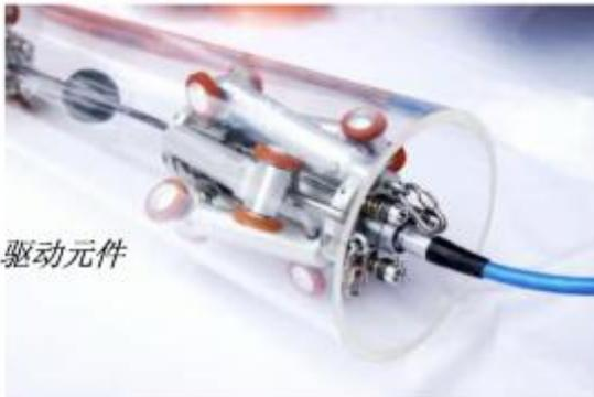
管道内检机器人系统大致由一个驱动元件和不同的视频头组成，后者或者永久的固定在驱动模块上，或可以通过插拨连接系统轻松替换。每个模块上都带有 6 个弹簧加压的驱动元件。强劲的微型电机，组合式行星齿轮传动，32 个径向滚珠轴承，12 个带有特殊橡胶涂层的轮子，这些会确保最大力量牵引，无论是粗糙或平缓表面，都得以在管路内部行走。6 个驱动臂各自有弹簧加压，确保设备在管路中央准确定位，不均匀表面及交叉处的微小变化也可以自动越过。
