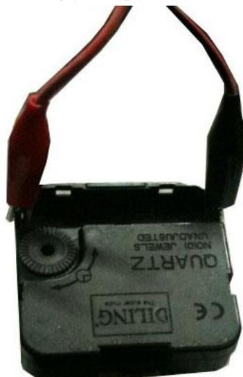
图 13. 石英机芯电流测试
