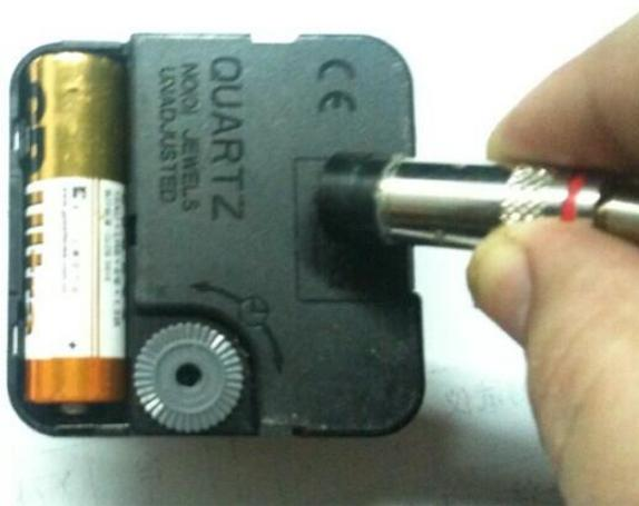
图 8. 探头测量石英机芯
