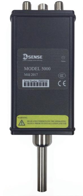
H2SENSE™ Model5000型氢气在线分析仪是一款操作简单、接口灵活，且真正意义上实现氢气在线检测的仪器，氢气测量从0.5%~100%vol。传感器采用固态钽合金薄膜技术，具有绝对的氢气专一性，不受CO、CH化合物等其他可燃气体的影响，甚至可以在H<sub>2</sub>S、湿Cl<sub>2</sub>等酸性环境中测量，适用于制氢、石化、制药、半导体等工业环境。
