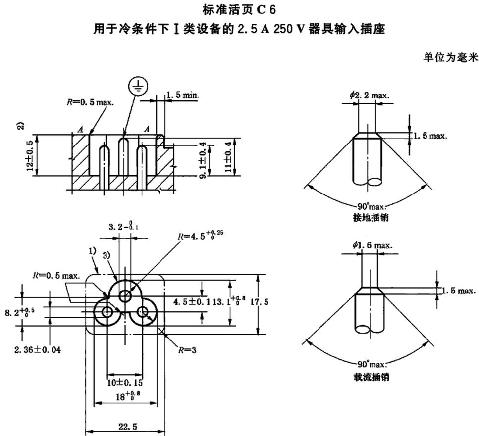
所使用的塑胶本体材料必须要过 750 度灼热丝测试，使用的五金材料必须是含铜量超过 60% 的材料，在标准要求中，最关键的结构是端子与插销之间的固定不是通过塑胶本体实现的，而是要求当塑料本体拆除后，端子与插销仍然结合牢固，这样要求的原因是当塑胶本体出现软化或老化时，导体不会因为松动而产生接触不良或产生电火花而导致漏电起火等极端灾害。
