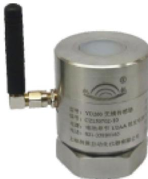
图 8.1 无线振动传感器节点
