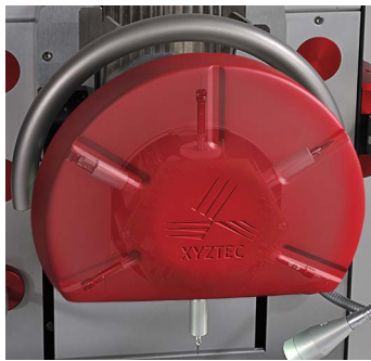
搭配 6 个传感器的旋转测量模块 RMU, 最大测力范围可达 200 公斤: 再也不需要手动更换模块
