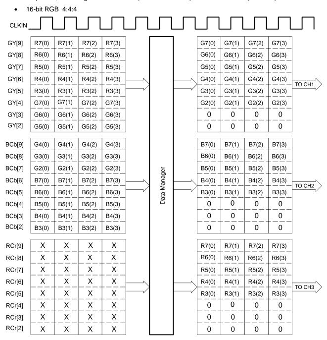
Figure 4-3. 16-Bit RGB 4:4:4 Data Format
