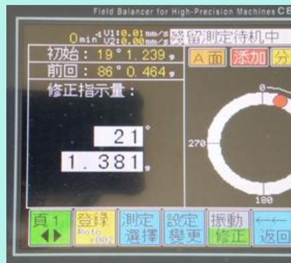
1、多面多速度平衡校正功能介绍：可以做柔性体转子的平衡校正，解决共 振动 不平衡量的位置和剩余不平衡量的质量：（如上图：21 度的地 平衡量。（在这个地方我们可以增加（或者在 201 度的地方减去）
