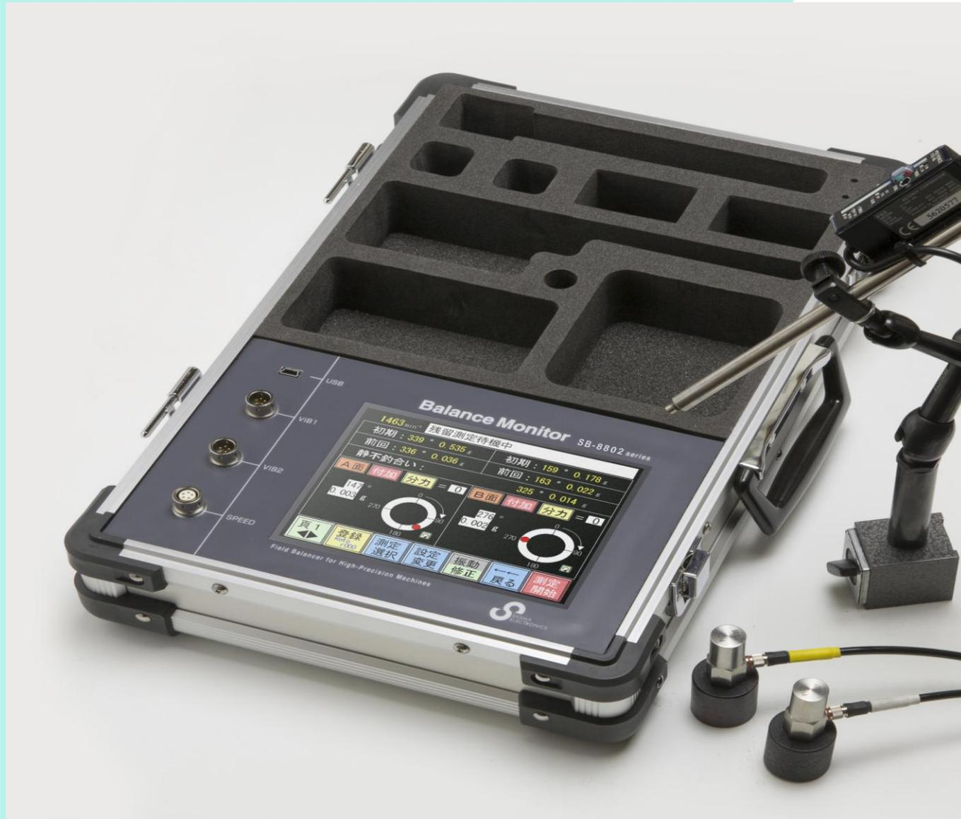
日本 SIGMA 公司生产的现场动平衡仪 CB-8802R 重 3.5kg，可对机床、离心机、风机、水泵等所有通用机械及高精度磨床的转子现场动平衡仪。校正结果可保存及打印输出。
