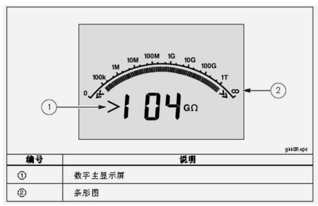
Fluke 1555/1550C 绝缘电阻测试仪
