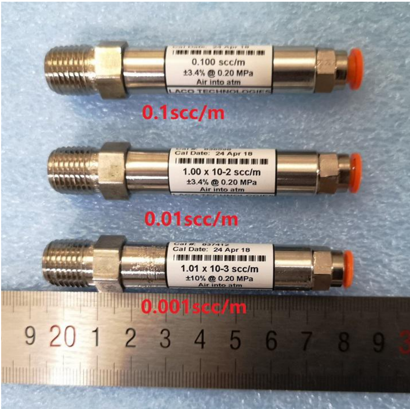
图 1：气密性漏孔实物照片：3 个定制漏率：0.1，0.01，0.001scc/m
