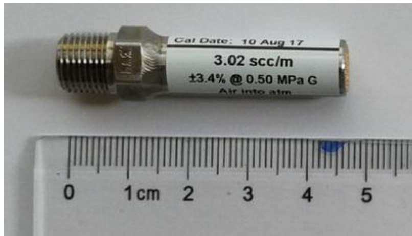
图 4：气密性漏孔实物照片：3sccm( \pm 5\% ) 标准漏孔
