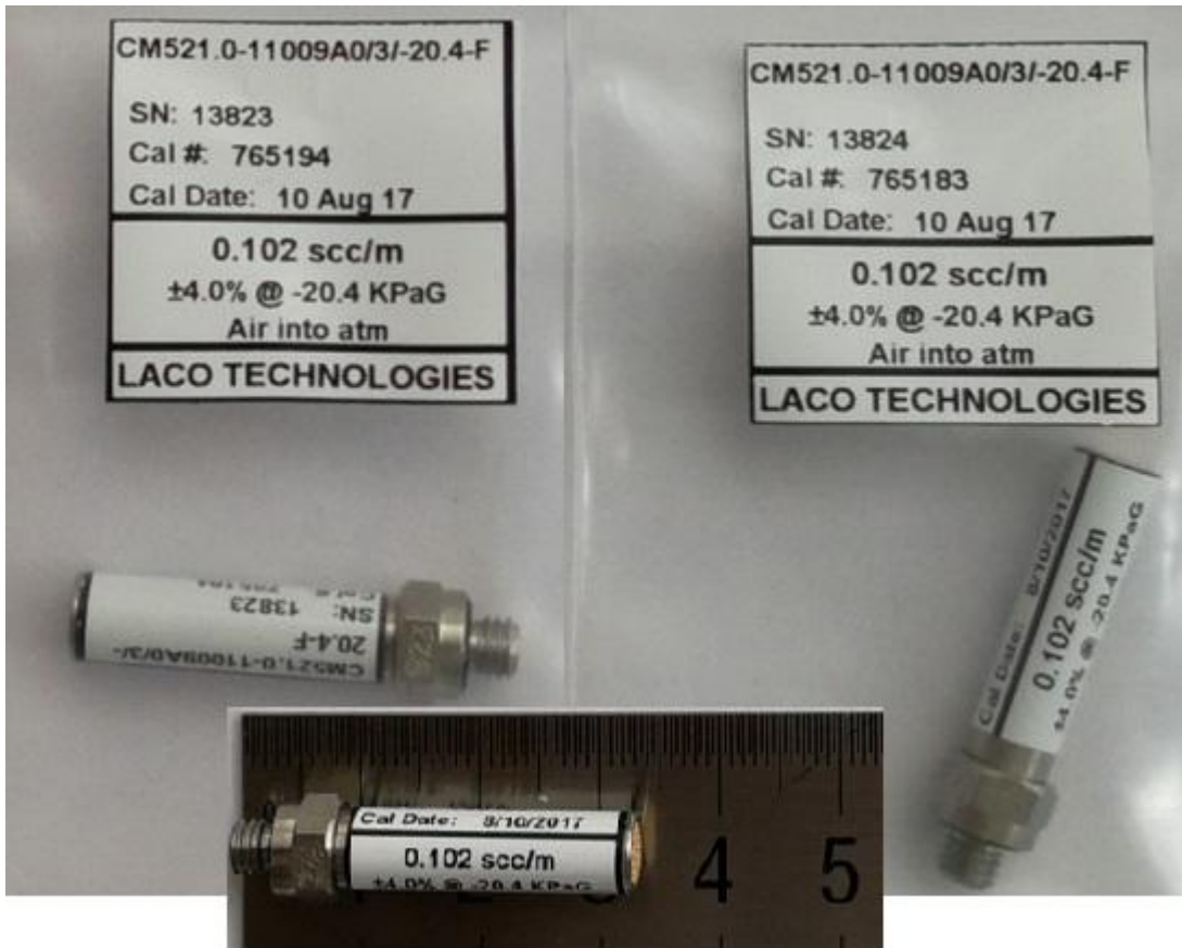
图 2：气密性漏孔实物照片：2 个定制的 0.1sccm( \pm 5\% ) 标准漏孔，用于模拟 IP67 防水测试 漏孔规格：10/32 外螺纹，长度：3.5cm，入口压力：大气，出口压力：- 20.4kpa，不确定度： \pm 4.0\%
