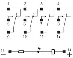
4Z直流带发光二极管和续流二极管
