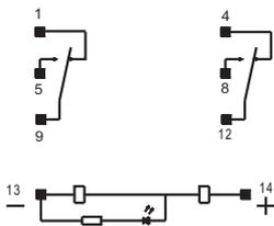
2Z直流带发光二极管和续流二极管
