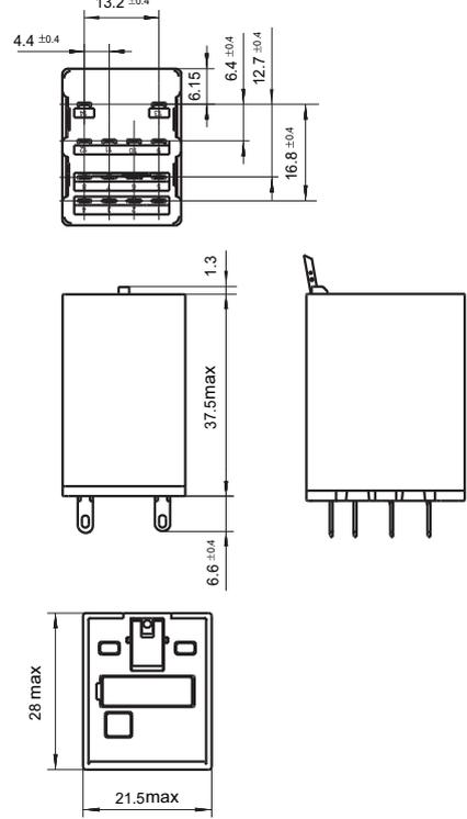
备注: 产品部分外形尺寸未注尺寸公差, 当外形尺寸 $\leq 1\text{mm}$ , 公差为 $\pm 0.2\text{mm}$ ; 当外形尺寸在 $(1 \sim 5)\text{mm}$ 之间时, 公差为 $\pm 0.3\text{mm}$ ; 当外形尺寸 $> 5\text{mm}$ , 公差为 $\pm 0.4\text{mm}$ 。
