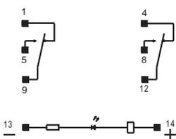
2Z直流带发光二极管和续流二极管
