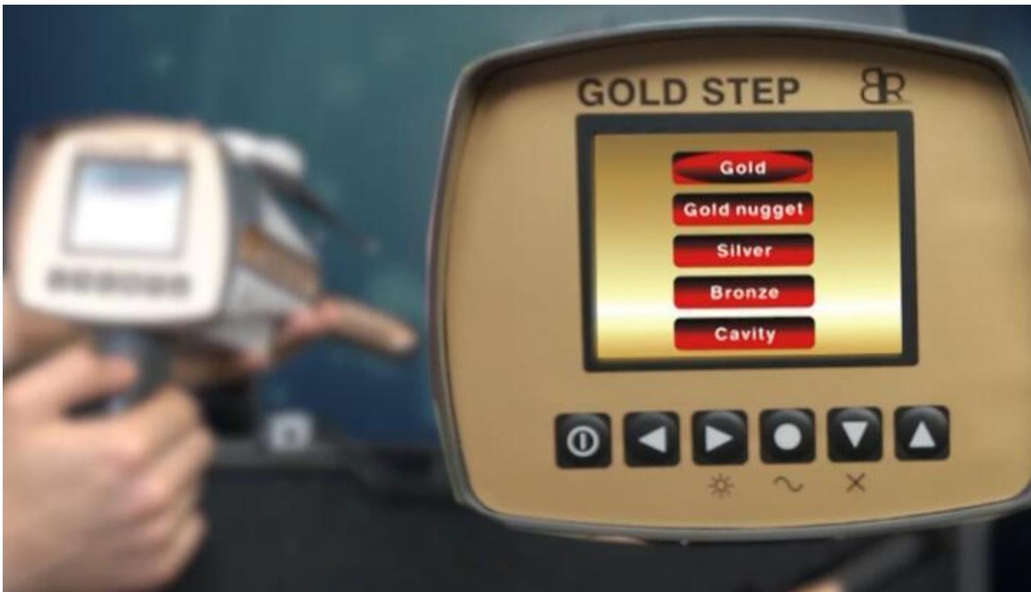
工作和勘探方法：我们将设备垂直地提升到土壤上，通过点击屏幕运行机器，并选择长期系统中的工作。然后我们选择例如目标类型（金）之后我们选择深度：（6米- 12米- 18米- 24米- 30米）然后我们设置远程访问所需的：（200米- 400米- 600米- 800米- 1000米），然后等待位装置送电功率地下，垂直和水平，然后我们走与扫描所需面积的装置。当该区域有目标时，该装置对该目标进行雷达液压运动，然后我们用设备移动，直到我们通过远程系统限制目标后到达目标。我们安装传感器后，运行磁强计程序，然后我们开始走在前面的方法已经确定的目标时，有一个声音在设备的屏幕上有一个可见的信号，在最后一点，我们确保目标是 100% 真实的。最后一步是确定目标的深度和工作。
