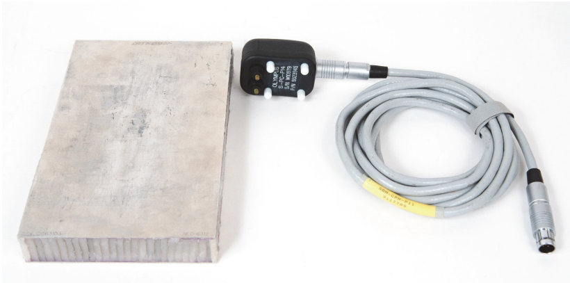
图 6-17 材料 — 锥形几何形状样件的蒙皮与蜂窝芯脱粘缺陷
