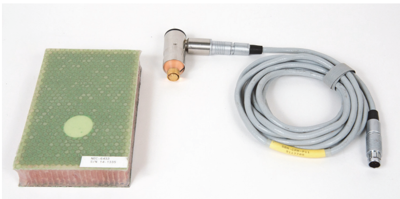
图 6-29 材料 — 使用机械阻抗分析技术探测修复（铸封）区域
