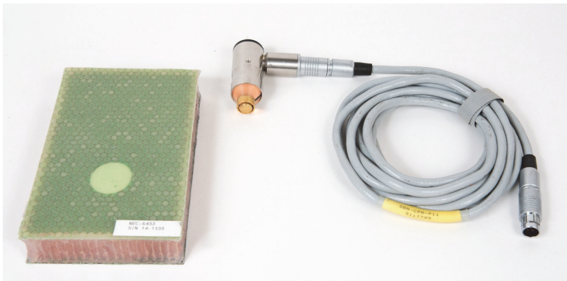
图 6-22 材料 — 使用机械阻抗分析技术探测更小的脱粘缺陷
