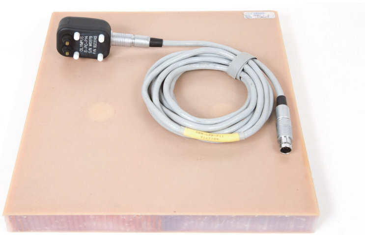
图 6-55 材料 — 使用一发一收扫频，分析频率响应
