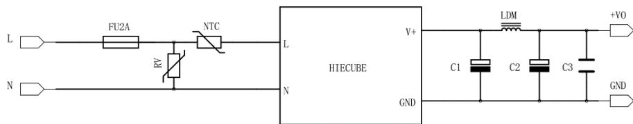
(注：输出滤波电容 C1.C2 为电解电容，建议使用高频低阻电解电容，容量和流过的电流请参考各厂商提供的技术规格。电容耐压降额大于 80%。C3 为陶瓷电容，去除高频噪声。推荐外接 NTC 热敏电阻，型号:10D-11。推荐外接 MOV 压敏电阻。)
