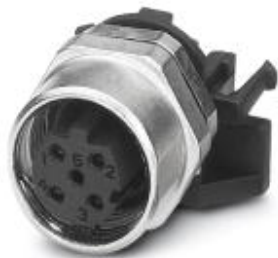
总线系统孔式插座，以太网，4芯，M12 SPEEDCON，D编码，板后/M12螺纹安装，带极性保护，直焊针
