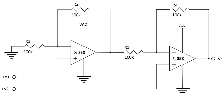
图 3 高输入阻抗, 直流减法放大器
