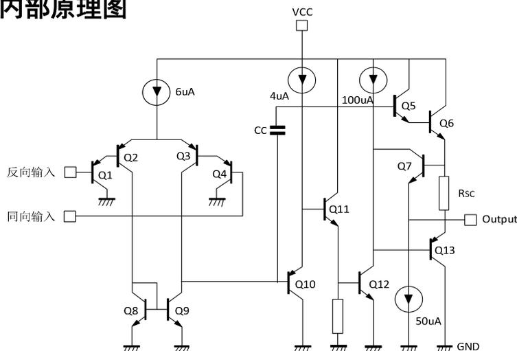
图 1 LM358 的内部原理图
