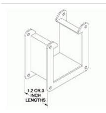
Les raccords pour chemin de câble sont livrés avec une plaque d'étanchéité spéciale qui ne peut être utilisée à proximité de raccords pivotants (utiliser des raccords de la série 1487).
