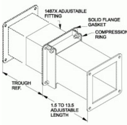
Permet un réglage sur place en longueur de 1,5 à 13,5 po.
