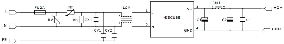
注：元件参数参考规格书的EMC低纹波电路
