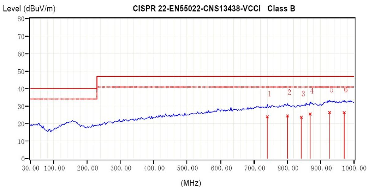
图2 HT6871S垂直方向EMI辐射图;
