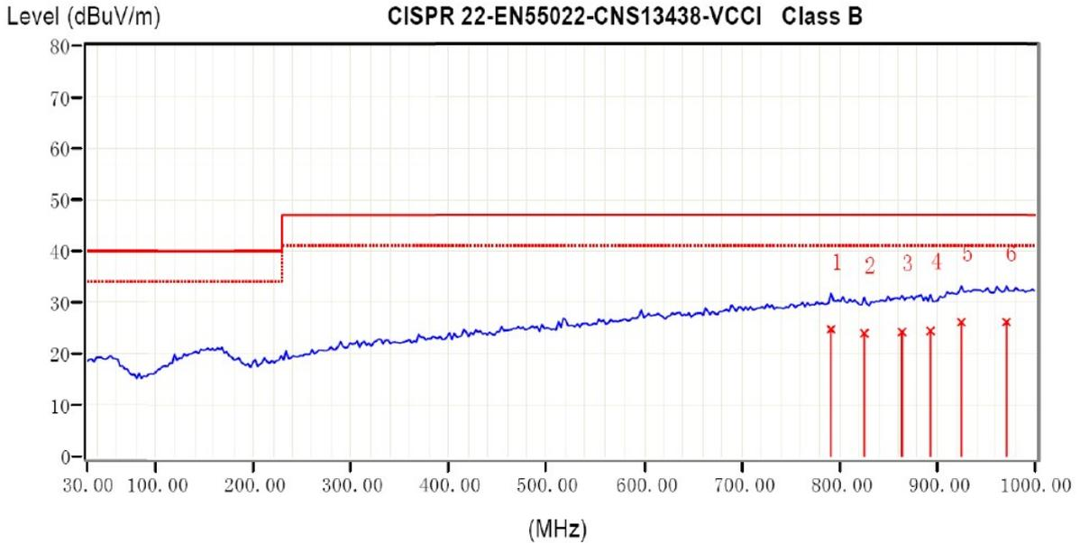
图3 HT6871S水平方向EMI辐射图;
