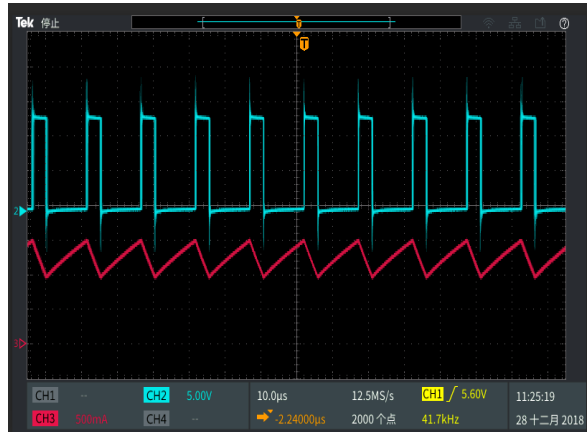
SW 脚与电感电流工作波形
