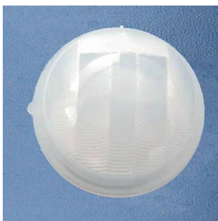
型号: N0803-32-4 尺寸: \phi 15.7*7.81 焦距: 6mm 感应角度: 120° 感应距离: 8m
