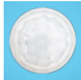
型号: 01809-2 尺寸: 17.8*11.95 焦距: 9mm 感应角度: 120° 感应距离: 8m
