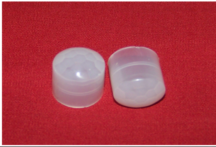
型号：8308-2 直径12.6mm 高：14.3mm 焦距：6 mm 感应角度：90° 感应距离：6 m
