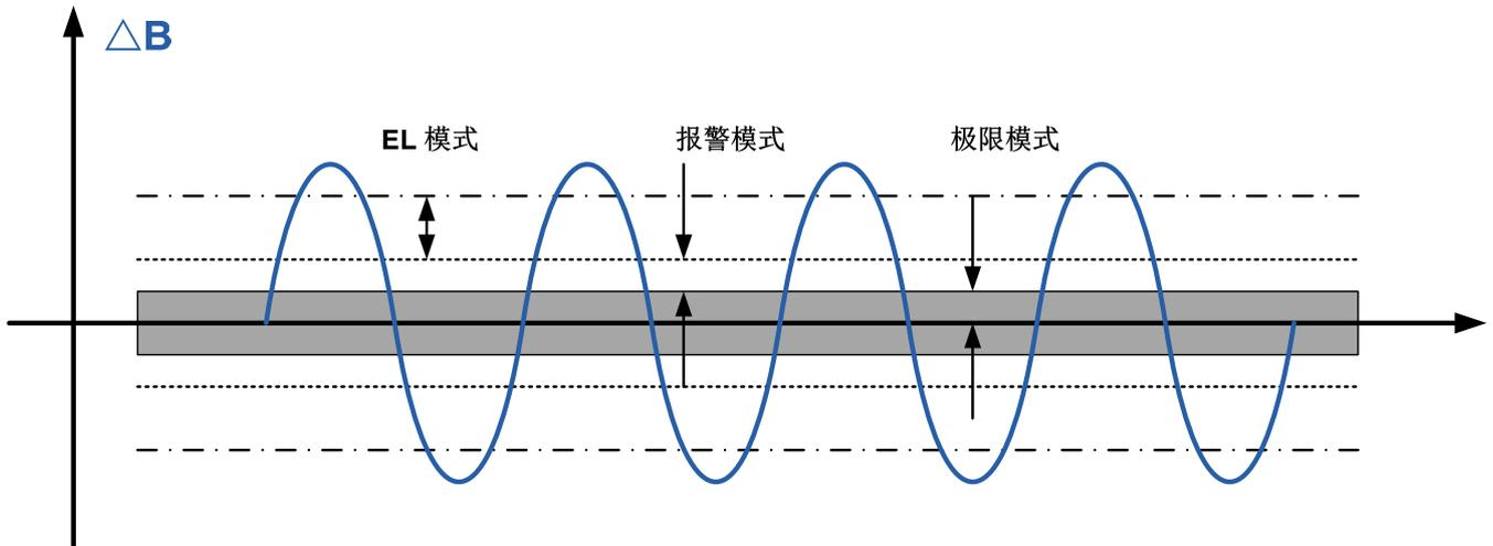
**报警模式:** 指示磁场强度低于一个关键值，即磁铁与芯片的间距达到了一个临界值，此模式仅在初始化校准模式出现
