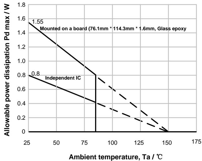
图 2 eTSSOP28 with PAD 额定参数曲线图
