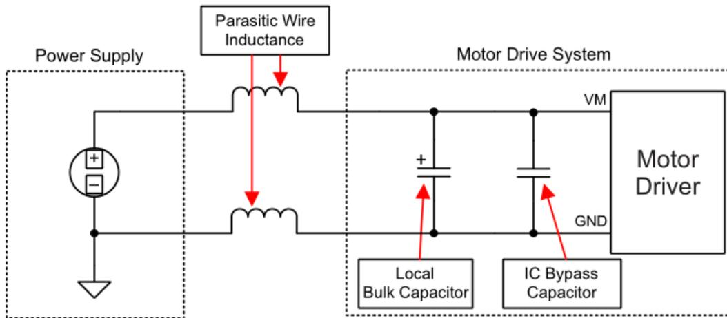
图 8. 外置电源电机驱动系统的设置
