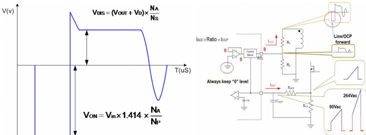
此脚提供可靠精准的输出OVP/UVP功能，阈值分别为 $V_{th-OVP}=3.5V$ 和 $V_{th-UVP}=0.8V$ 。
