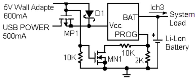
图5：交流适配器与 USB 电源的组合
