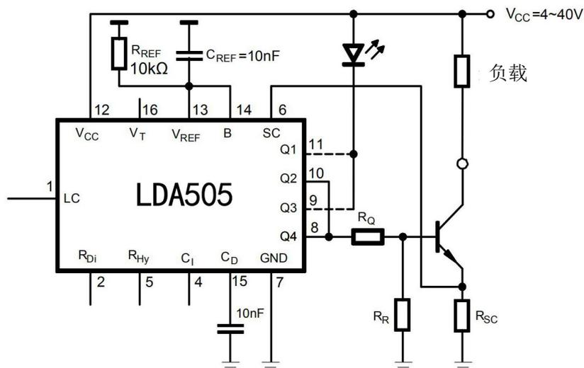
输出电路使用了  $V_{REF}$ 、B、SC、Q1、Q2、Q3、Q4、 $C_D$  八个引脚
