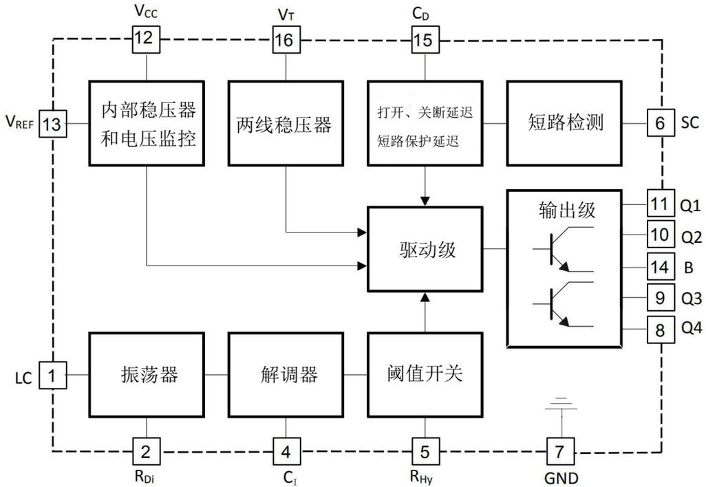
图 1. LDA505 内部结构框示意图
