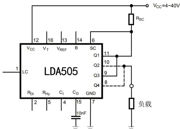
输出电路使用了 SC、Q1、Q2、Q3、Q4、C<sub>D</sub> 六个引脚
