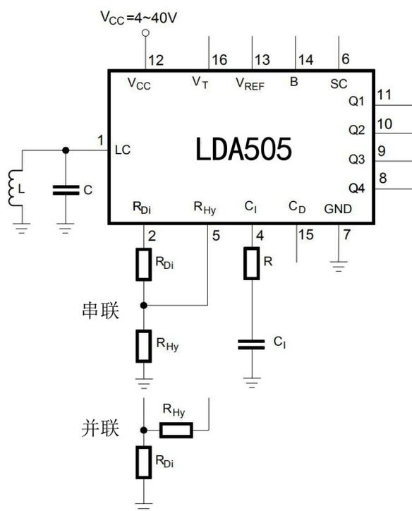
输入电路使用了 LC、 $R_{Di}$ 、 $R_{Hy}$ 、 $C_i$  四个引脚
