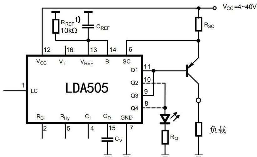
输出电路使用了  $V_{REF}$ 、B、SC、Q1、Q2、Q3、Q4、 $C_D$  八个引脚
