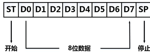
图 7. Modbus 通信格式
