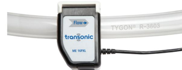
PXL 系列夹式管内流量探头，可以在不妨碍管道内液体流动的情况下灵活应用于各种实验室和体外管道，具有安装简便，可重复性高等特点。传感器和液体之间完全隔离。
