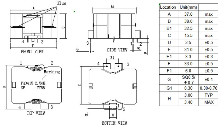
Sunlord 高频变压器 PQ34 系列磁芯具有多款不同尺寸、不同损耗，可以满足不同客户要求。如下为磁芯举例及对应损耗：
