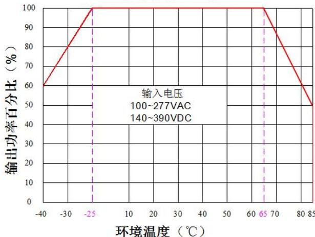
注 1：输入电压为 85~100VAC/277~305VAC/120~140VDC/390~430VDC，需在输入电压降额曲线图的基础上进行电压降额使用。
